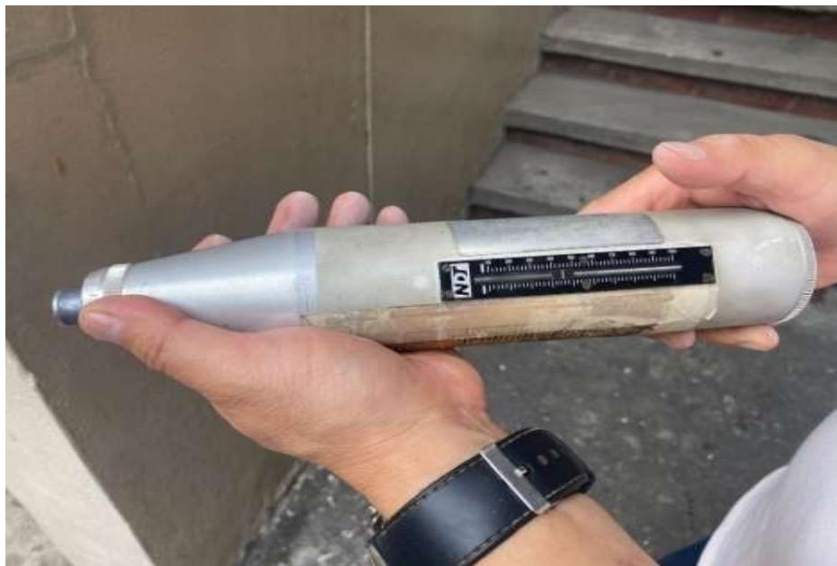
*Ilustración 13: Esclerómetro.*
