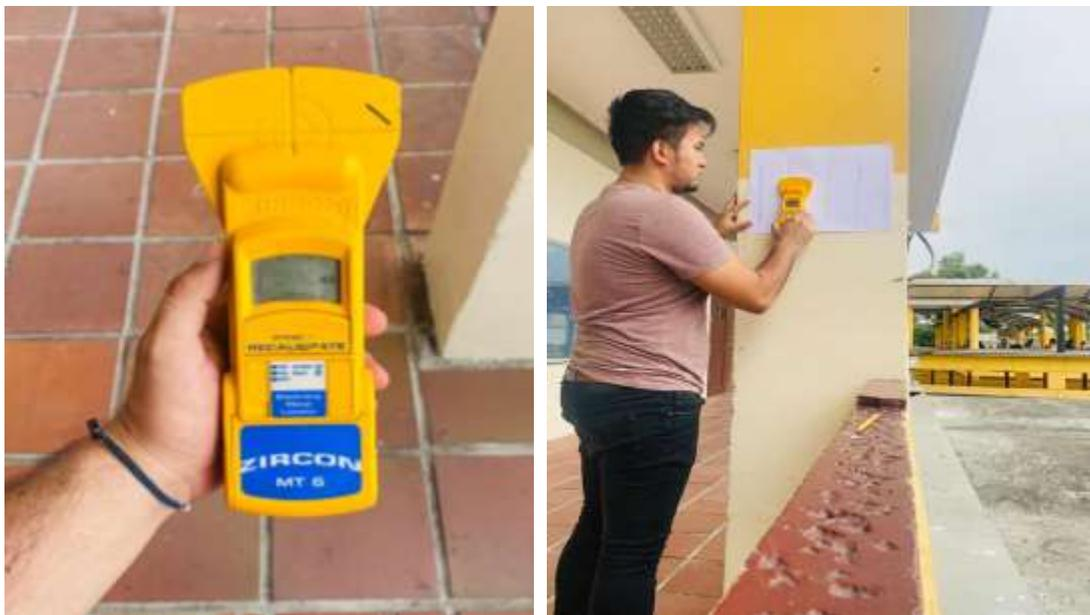
*Ilustración 16: Escáner del acero de refuerzo.*
