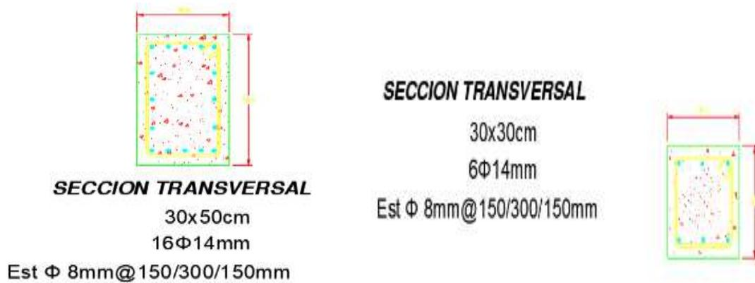
*Ilustración 17: Acero de refuerzo longitudinal y transversal.*
