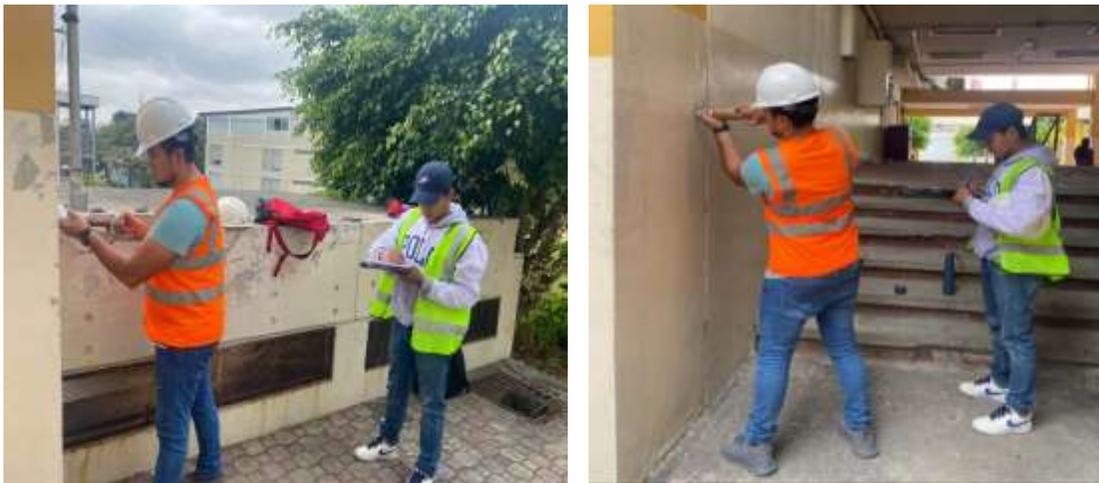
*Ilustración 15: Toma de muestra con el esclerómetro.*
