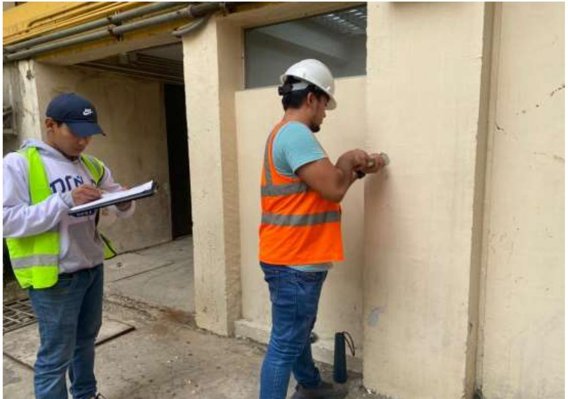
*Ilustración 59: Ensayo de esclerometría.*
