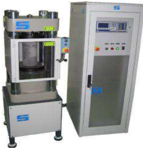
*Ilustración 12: Máquina de compresión simple para hormigón.*
