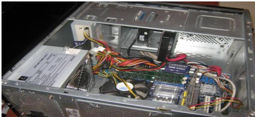
**Nota.** Se muestra como está ensamblado el servidor luego de haber implementado las dos SSD de 128 GB, 240 GB y el HDD de 240 GB,
