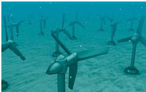
Figura 6 Generadores de rotor abierto
