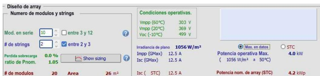
Figura 18 Diseño de array con paneles de 210 W.
