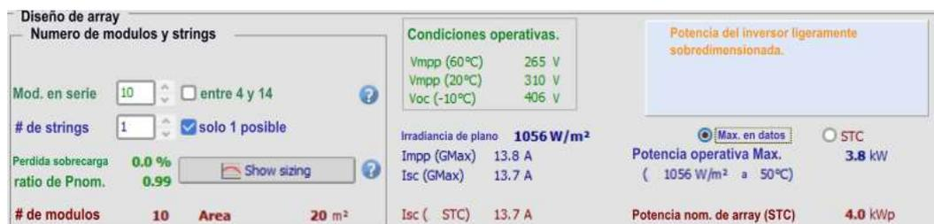
Figura 20 Diseño de array con paneles de 395 W.
