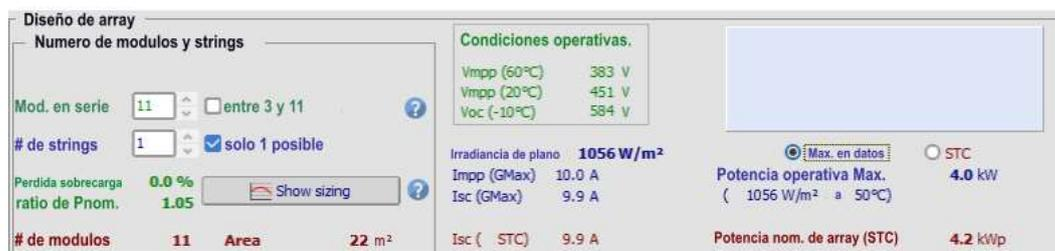
Figura 19 Diseño de array con paneles de 380 W.
