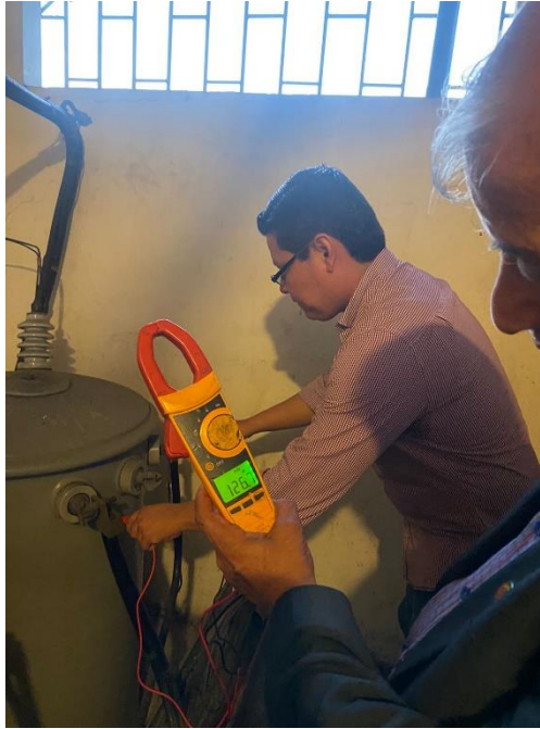
Figura 3. 22 Voltaje Nominal V_c
