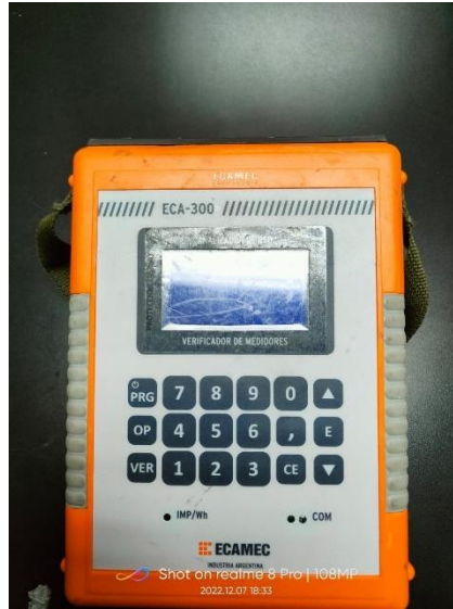
Figura 29 Equipo de medición trifásico ECAMEC (ECA-300)
