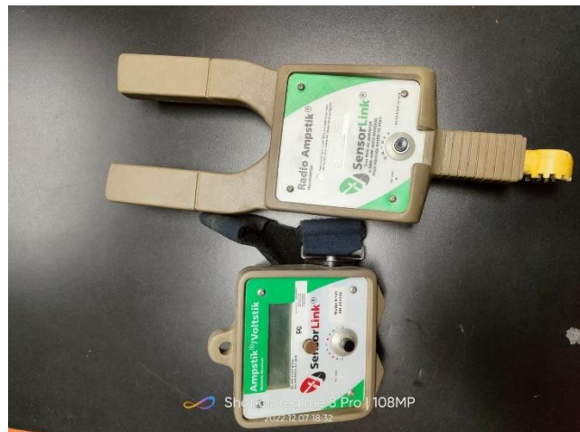
Figura 28 Amperímetro de media tensión vía radio frecuencia
