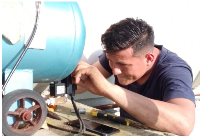
Figura 3.9: Conexión de Arduino con bobina Elaborado por: El Autor
