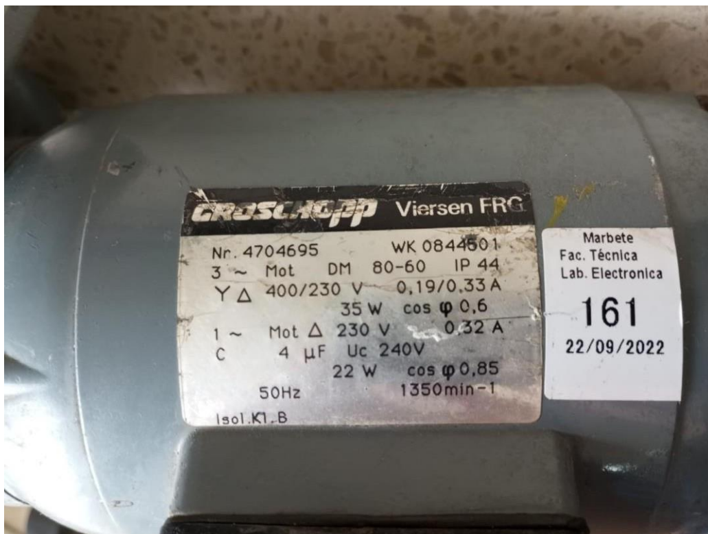
Anexo 7. Etiqueta de las características del motor.
