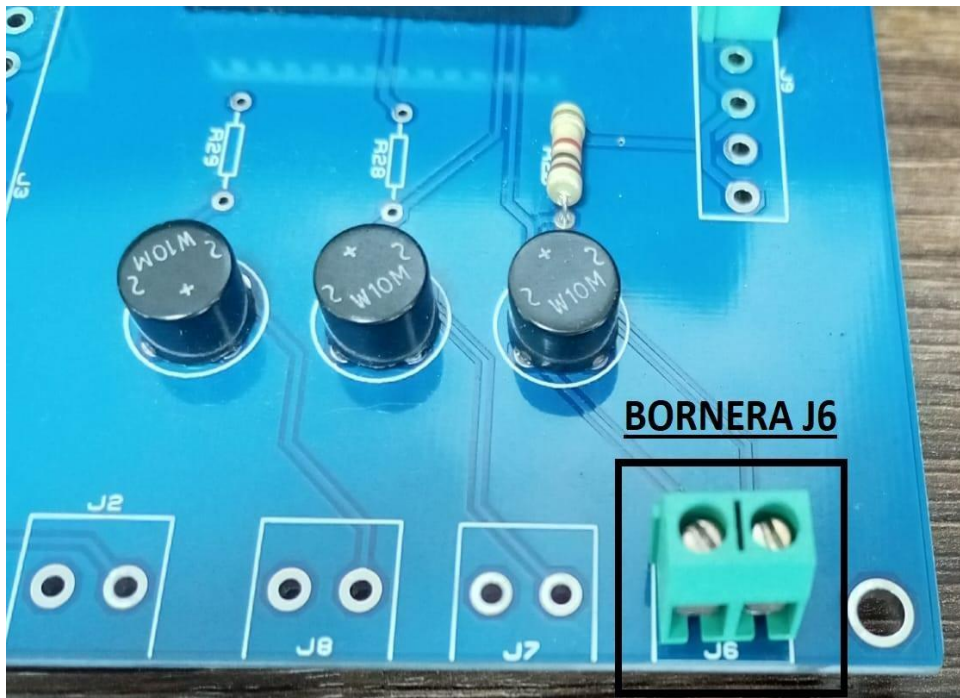
Figura 43 Bornera J6 de conexión del CT.
