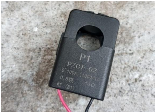
Figura 5 Transformador de corriente.
