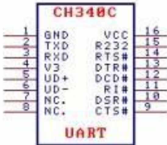
Figura 18 Configuración de pines del CH340c.
