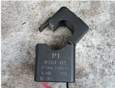
Figura 6 Pinza del transformador de corriente.
