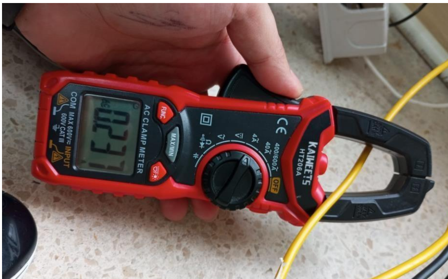
Figura 55 Amperaje requerido por el motor en conexión Y-Y.
