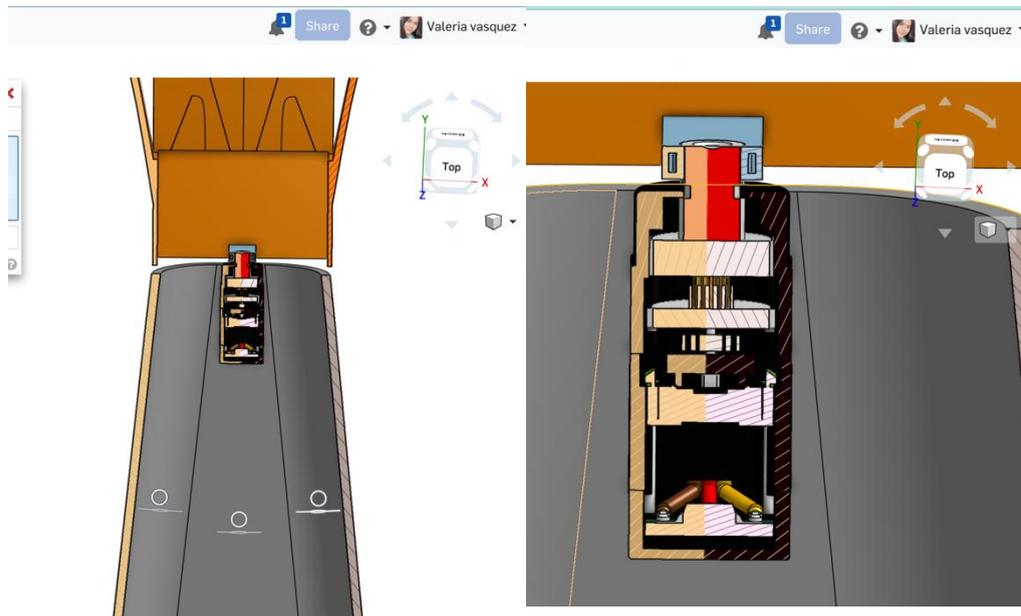
Anexo C. Diseño e implementación de un motor de rotación para darle movimiento a la muñeca .
