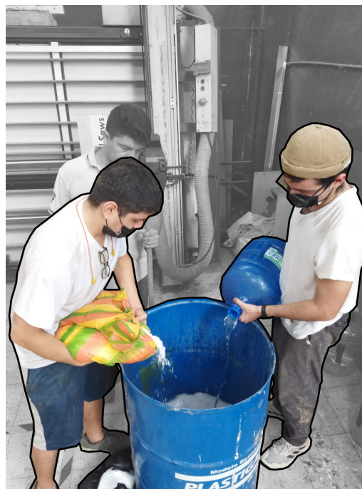
Figura 102. Inmunización en tanque de 55 gl
