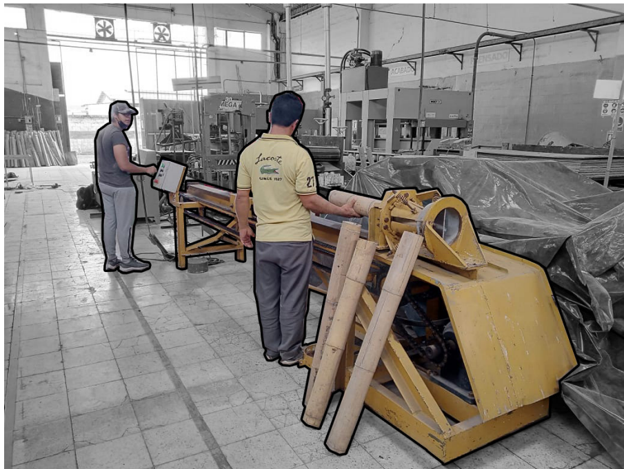
Figura 85. Latillado de la caña guadua
