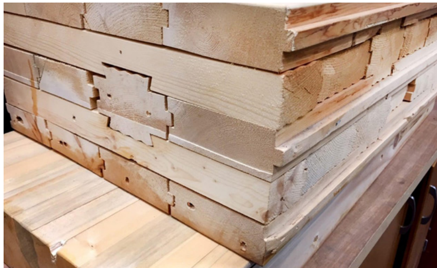
Figura 10. Vista de panel ICLT con unión de cola de milano
