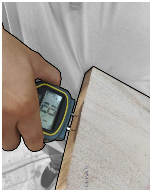
Figura 104. Medición de humedad
