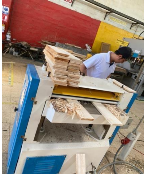
Imagen 4. Cepilladora eléctrica, cada pieza tenía una dimensión de 10x55x1.5cm
