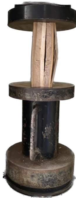
Imagen 17. Prueba de compresión en el laboratorio del CEINBES.
