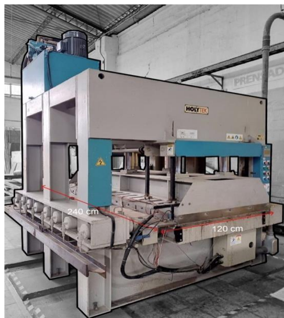
Imagen 11. Prensado de los paneles CLT.
