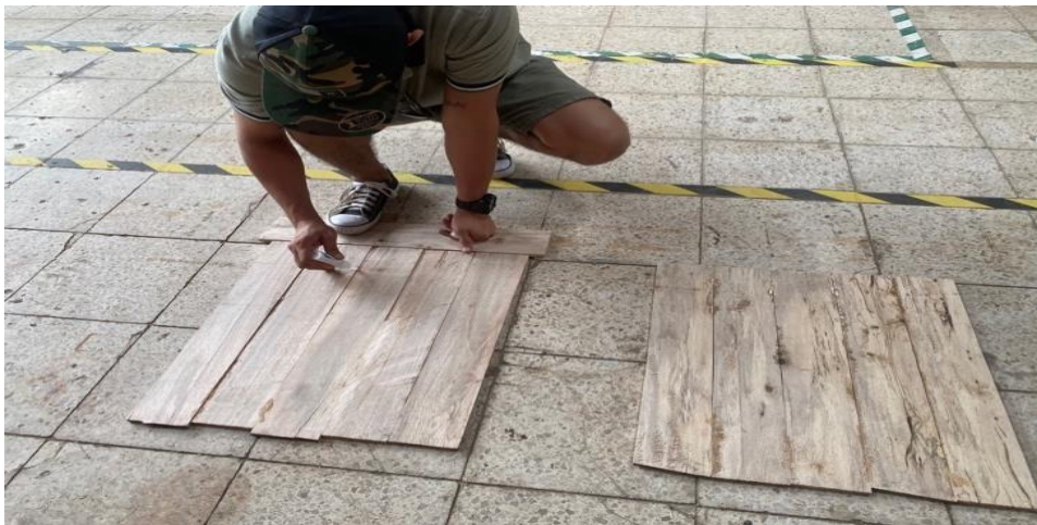
Imagen 9. Aplicación de pegante de secado rápido para unión de las capas.
