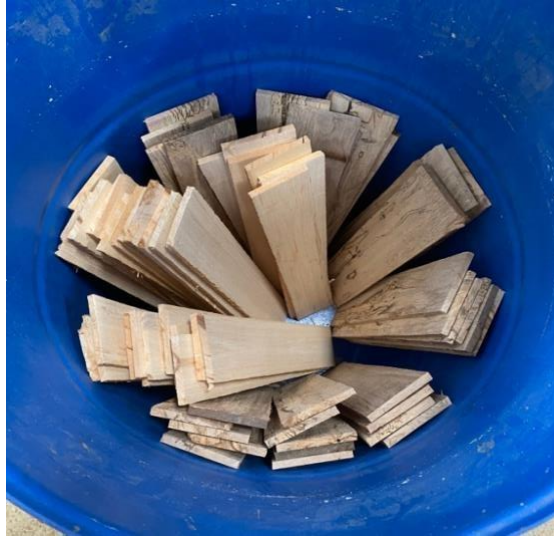
Imagen 7. Inmersión de madera en recipiente para su inmunización.
