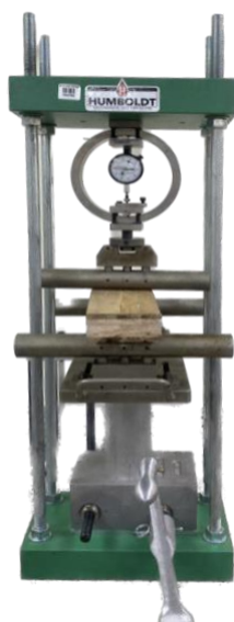
Imagen 15. Prueba de flexión en el laboratorio del CEINBES. Ilustración propia.
