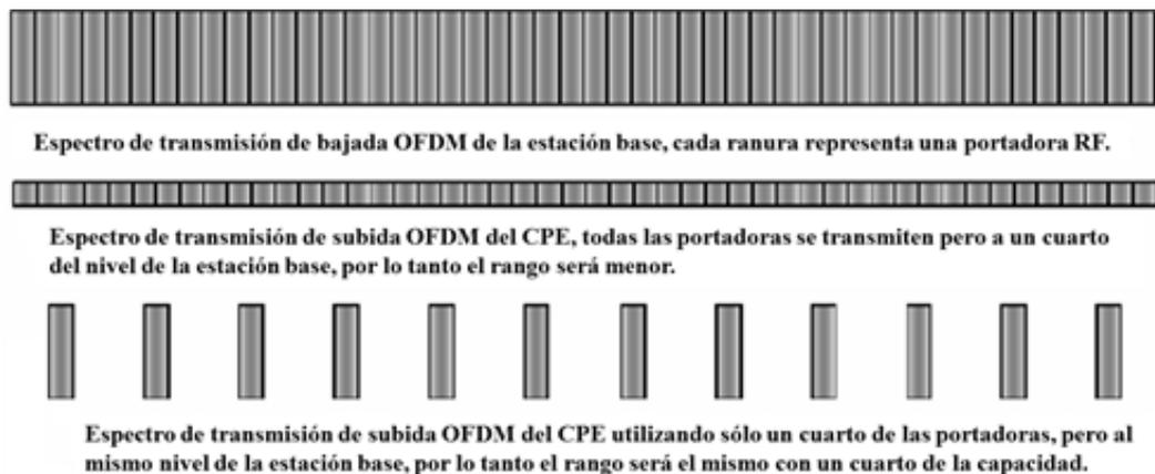
**Figura 2.1: Efecto de la subcanalización.**
