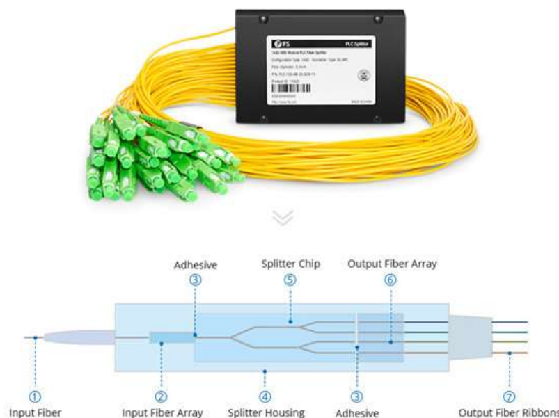
Figura 2.19 Divisor Óptico Planar
