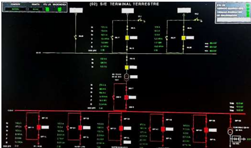
Figura 3.15 Diagrama unifilar de la subestación Terminal Terrestre.
