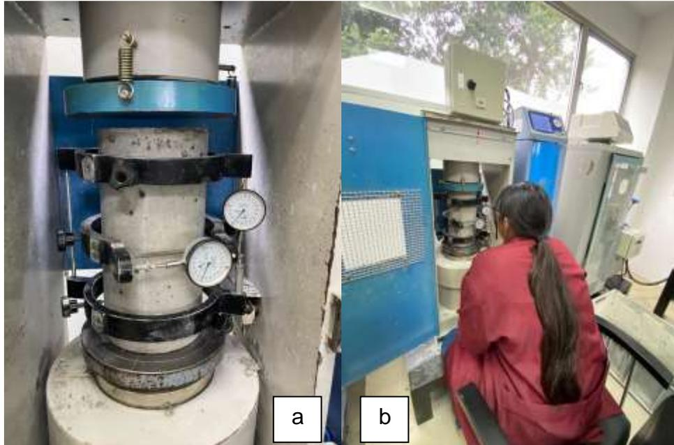
Nota: a. Colocación del cilindro con los anillos de lectura para el ensayo en la máquina y b. Lectura de los valores en el ensayo. Fuente: Elaboración propia.
