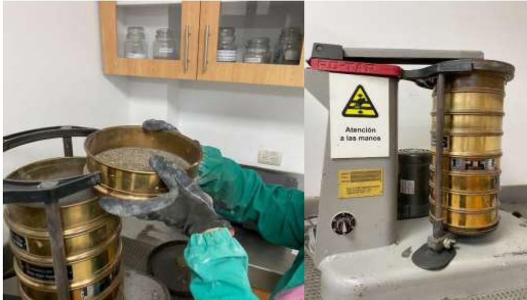
Nota: En el lado derecho se muestra la arena de río siendo colocada en la tamizadora, mientras que en el lado izquierdo se presenta la máquina de tamizado. Fuente: Elaboración propia.
