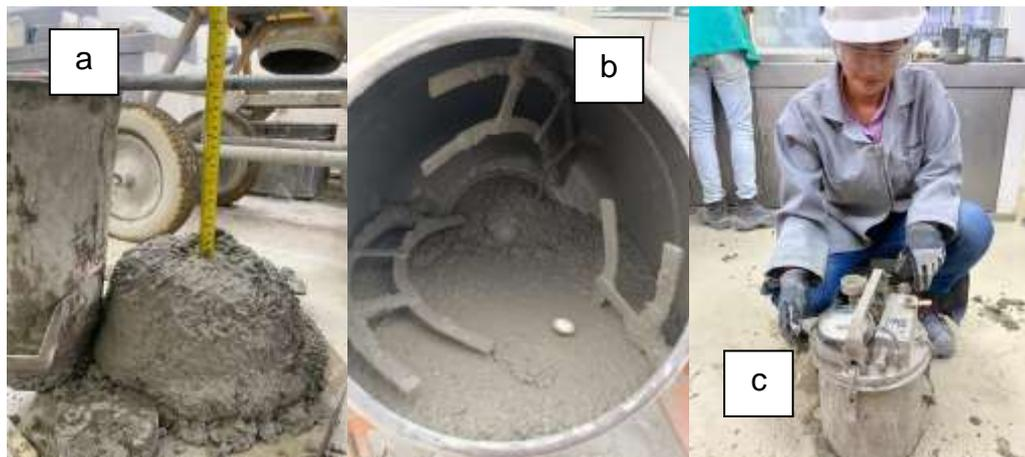
Nota: a. Ensayo de revenimiento, b. Ensayo de temperatura y c. Ensayo de contenido de aire. Fuente: Elaboración propia.
