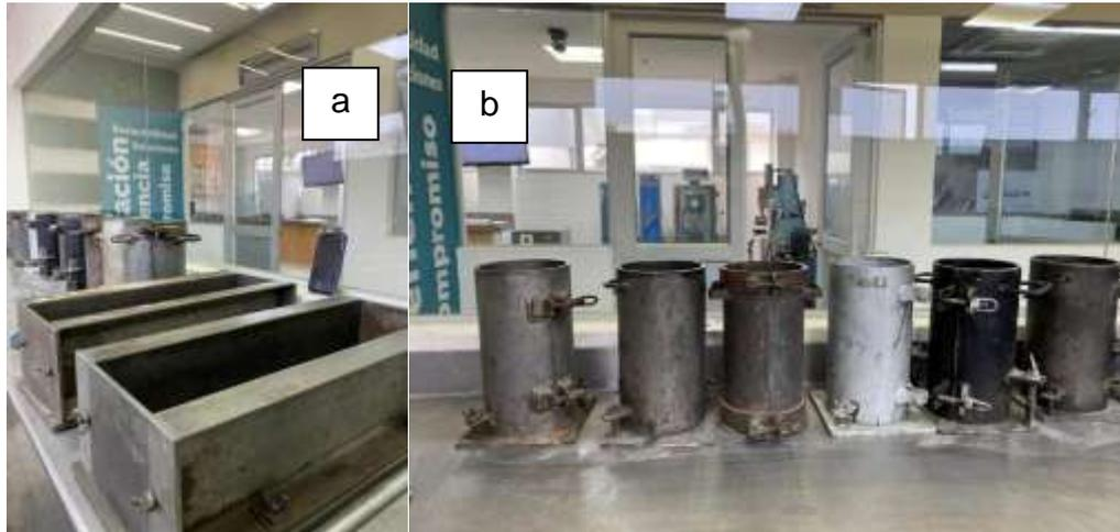
Nota: a. Moldes de viga y b. Molde de cilindros. Fuente: Elaboración propia.
