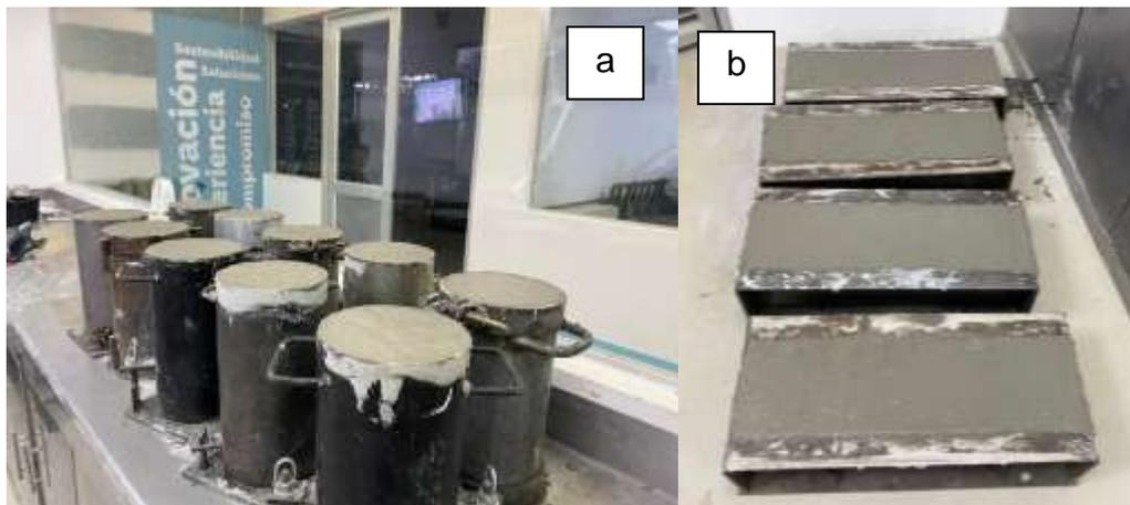
Nota: a. Los especímenes de cilindro y b. Los de viga. Fuente: Elaboración propia.
