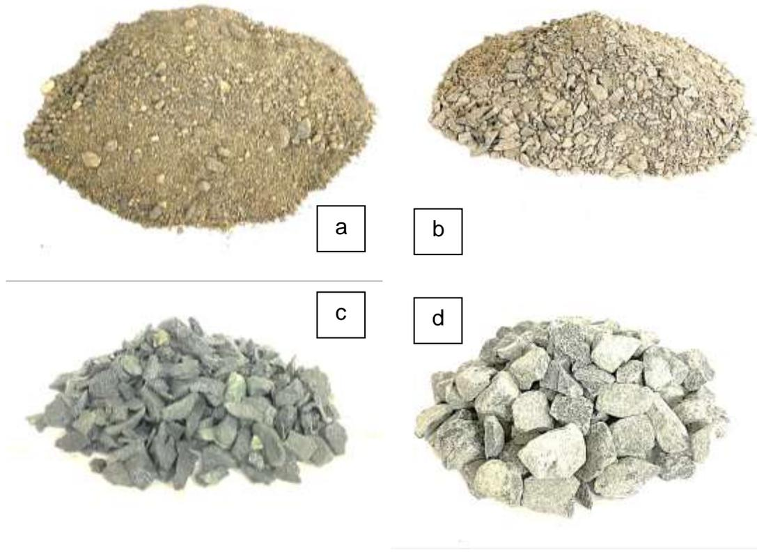
*Nota: a. Se muestra la Arena de Río, b. Es la Arena triturada, c. Piedra de 12 mm del diseño de HAD y d. Piedra de 19 mm del diseño de HC. Fuente: Elaboración propia.*
