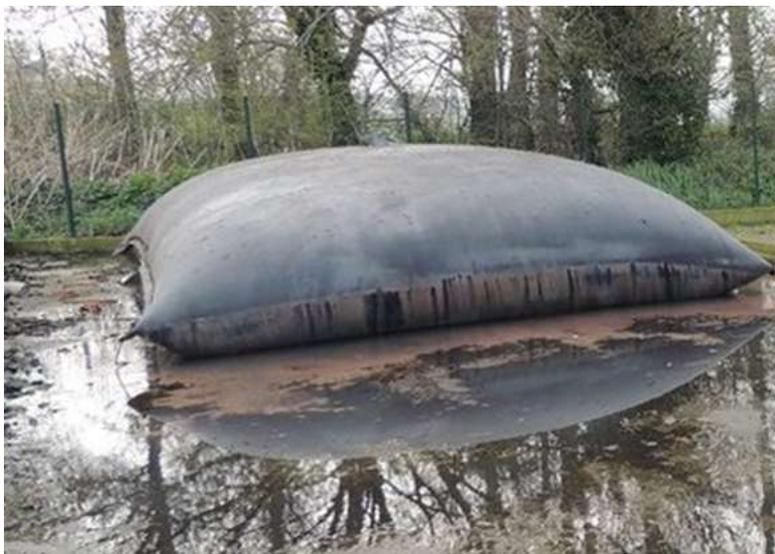
*Nota.* Tomado de *La depuradora de aguas residuales de Conques-Villalier equipada con Geotubos*, por La Depeche.fr, 2013, <https://www.ladepeche.fr/article/2013/04/17/1607417-la-station-d-epuration-de-conques-villalier-equipee-de-geotubes.html>
