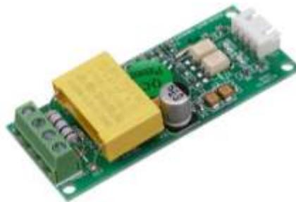
*Nota: Sus funciones abarcan la medición de voltaje, corriente, potencia activa, energía utilizada y factor de potencia.*
