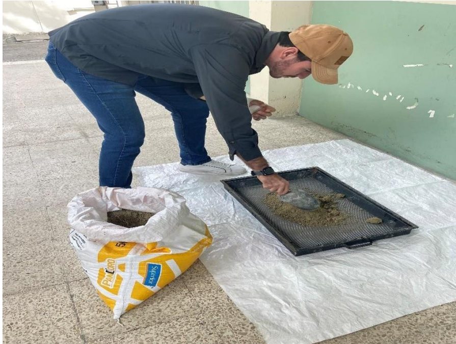
Figura 79. Tamizado de material de arcillas expansivas por el tamiz 40.
