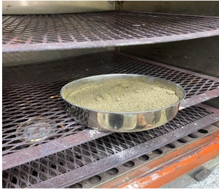
Figura 73. Arcillas expansivas en horno para eliminar la humedad en sus partículas.
