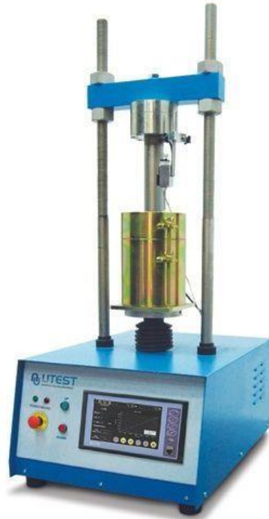
Figura 30. Máquina Automática para Ensayos de CBR.
