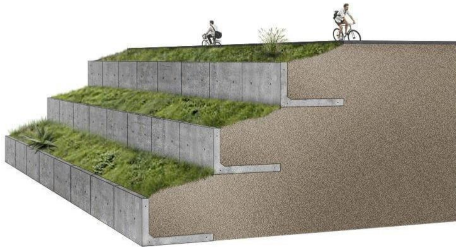
Figura 58. Muro de contención de tierras.
