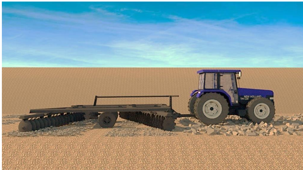
Figura 107: Tractor agrícola con rastra
