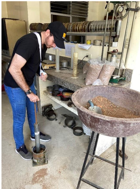
Figura 91. Compactación de prueba de Proctor de la mezcla.
