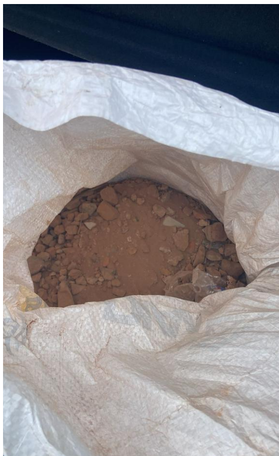
Figura 71. Desechos de materiales de construcción triturados.
