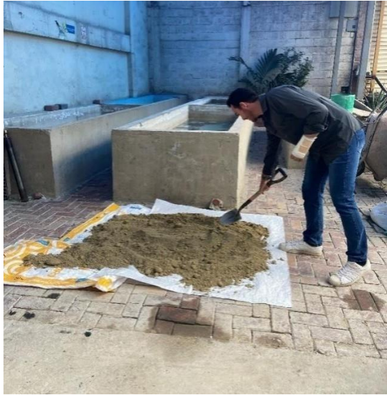
Figura 75. Arcillas expansivas siendo tendidas para su secado.
