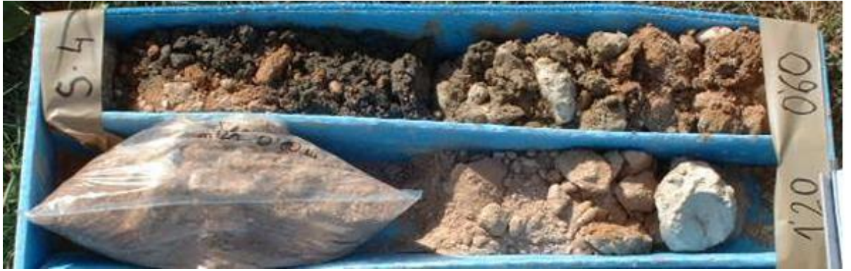
Figura 44. Muestras alteradas obtenidas de sondeo a rotación mediante batería simple.
