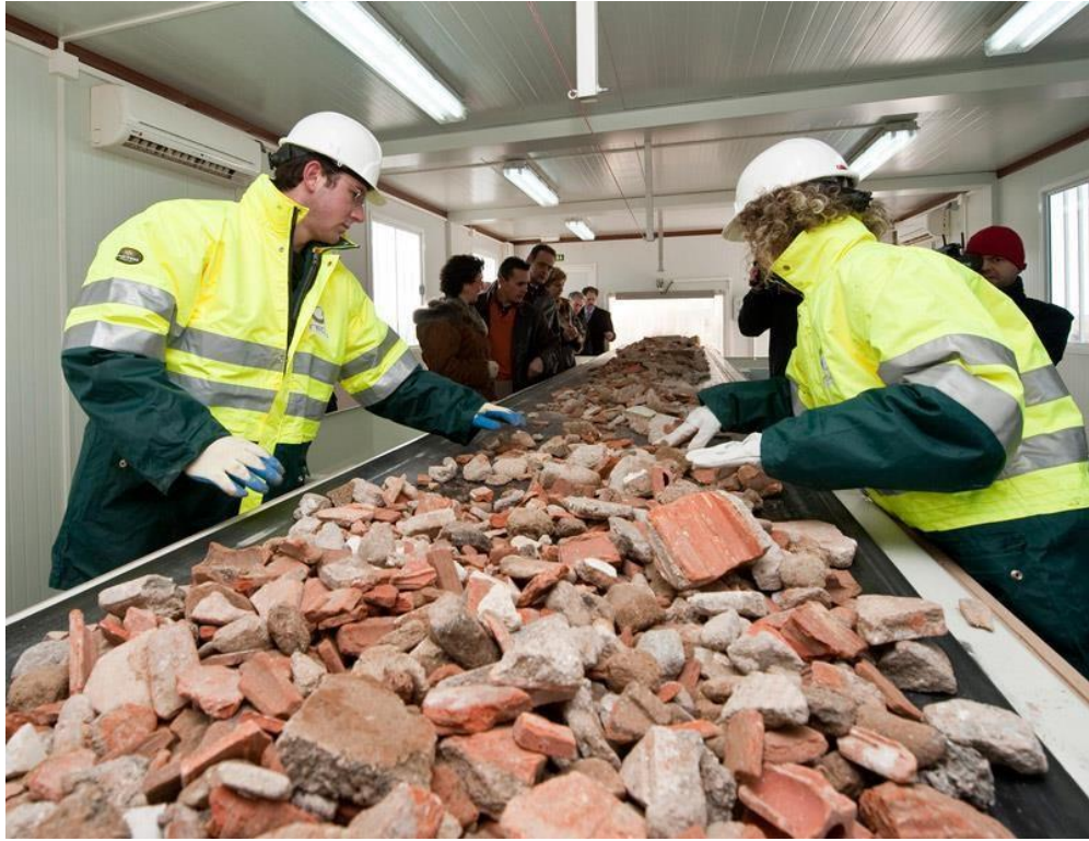
Figura 61. Gestión de desperdicios y reciclaje de materiales de demolición.
