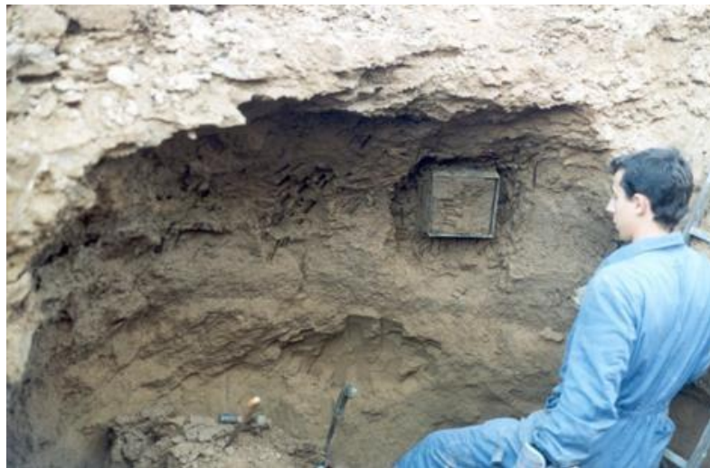
Figura 45. Muestras inalteradas, obteniendo la estructura y humedad natural del suelo.
