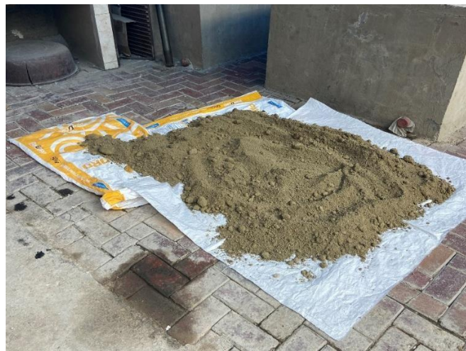
Figura 74. Secado de arcillas expansivas durante 24 horas.
