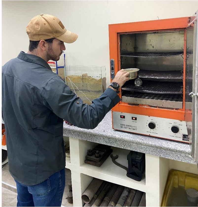
Figura 72. Muestra de arcilla expansiva siendo colocada en horno.
