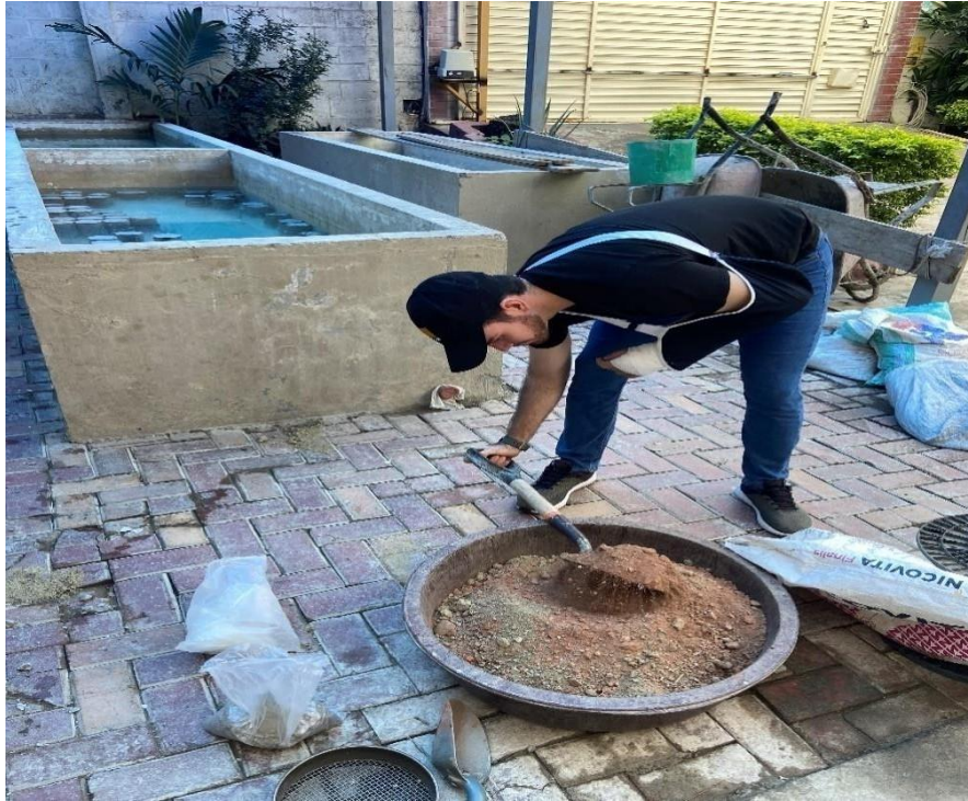
Figura 77. Proceso de mezcla 70 % arcilla 30 % escombros triturados.
