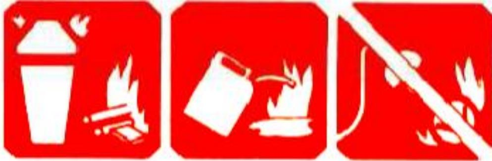
Figura 16: Señalización para el uso de extintores para Incendio Clase A y B Fuente: <http://www.bomberosquito.gob.ec/>
