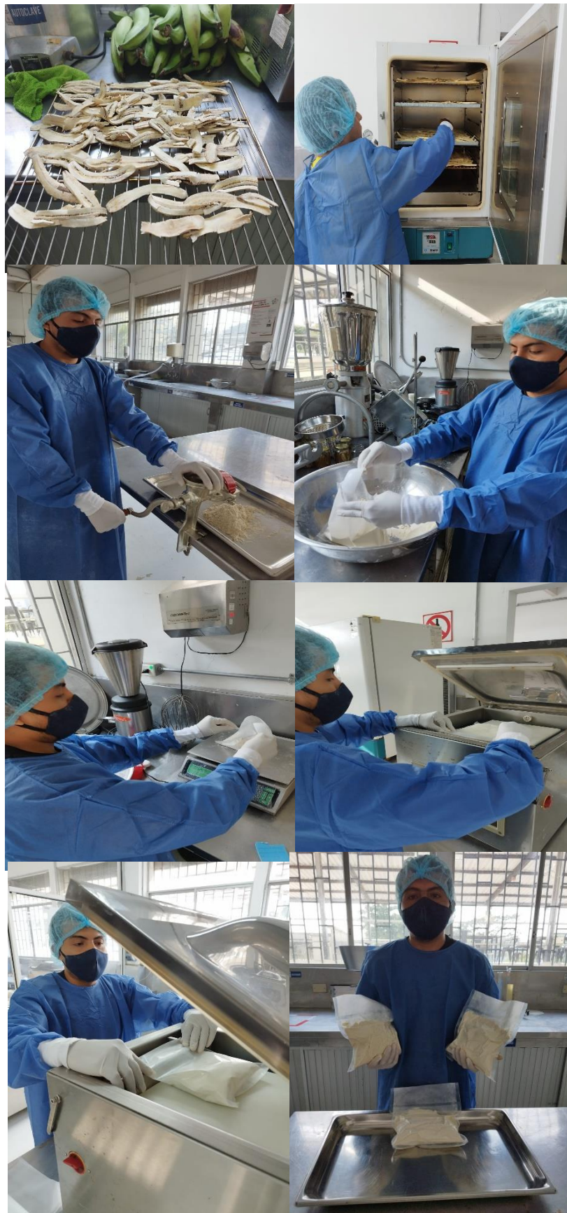
Figura 53 Deshidratado, Molienda y Empacado de la Harina de Plátano a 60°
