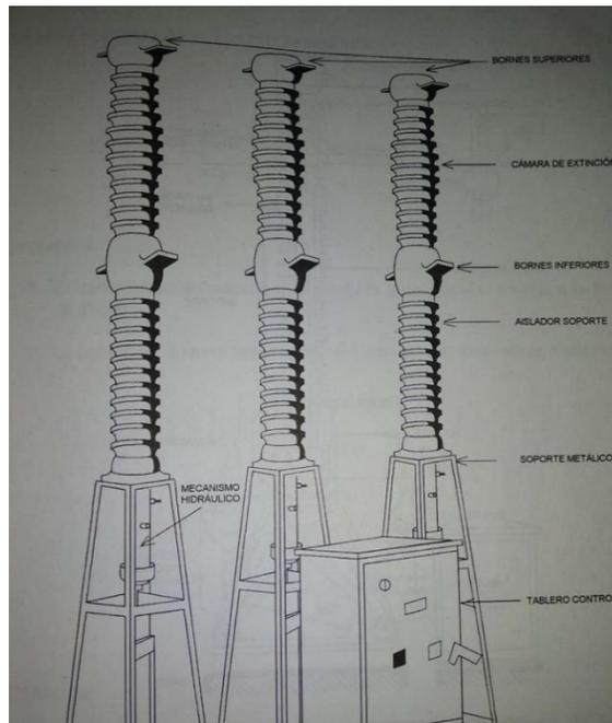
Figura 2.4. Partes externas de interruptor en sf6
