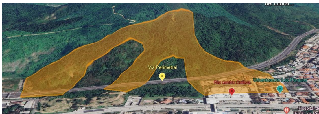
Figura 22. Simulación del impacto total que recibiría la urbanización Los Parques, a causa del deslizamiento de Cerro Azul
