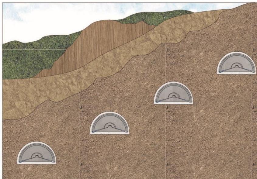
Figura 102. Vista transversal del esquema de túnel de drenaje profundo de 2 m de diámetro junto a sus paraguas de drenaje subverticales y un sistema de regulación de aguas subterráneas dentro del túnel
