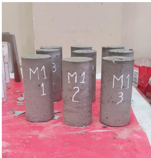
Figura 60 Cilindros de lechada cementicia desmoldadas.
