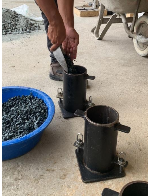
Figura 73 Moldes llenos de agregado grueso.
