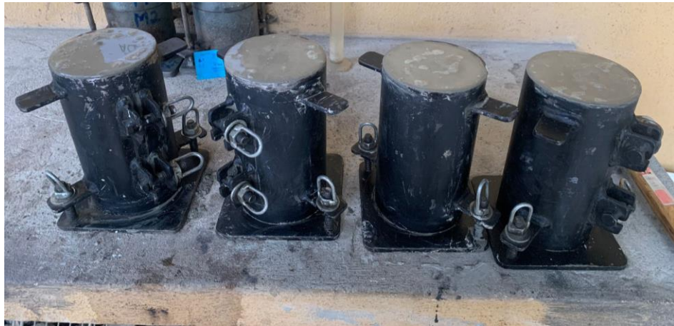
Figura 75 Moldes llenos de agregado grueso y lechada cementicia.
