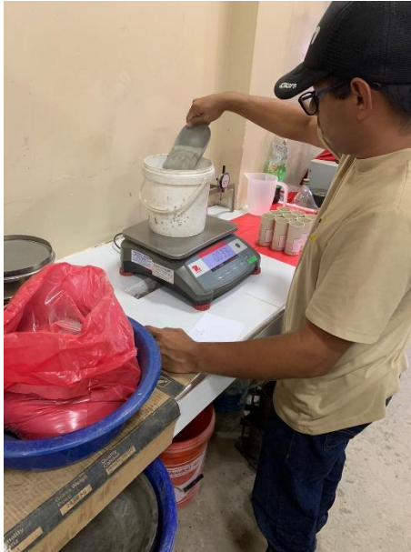
Figura 55 Cuantificación de cemento a utilizar.
