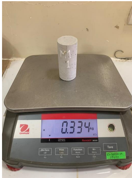
Figura 61 Pesaje de cilindro compuesto de lechada cementicia.
