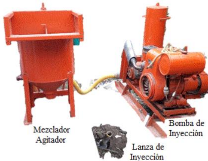
Figura 35 Equipos de inyección de lechada.
