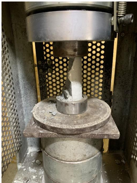
Figura 64 Cilindro con lechada cementicia después de la rotura.
