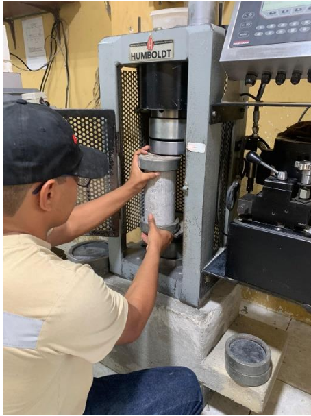
Figura 78 Cilindro del material piedra-cemento antes de la rotura.
