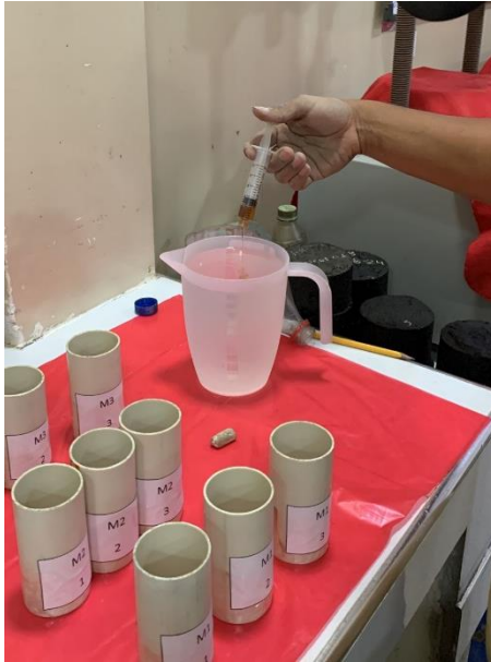
Figura 57 Cuantificación y mezclado de aditivo plastificante.
