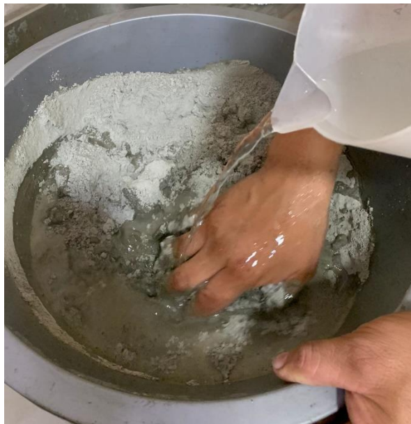
Figura 58 Mezclado de la lechada cementicia.
