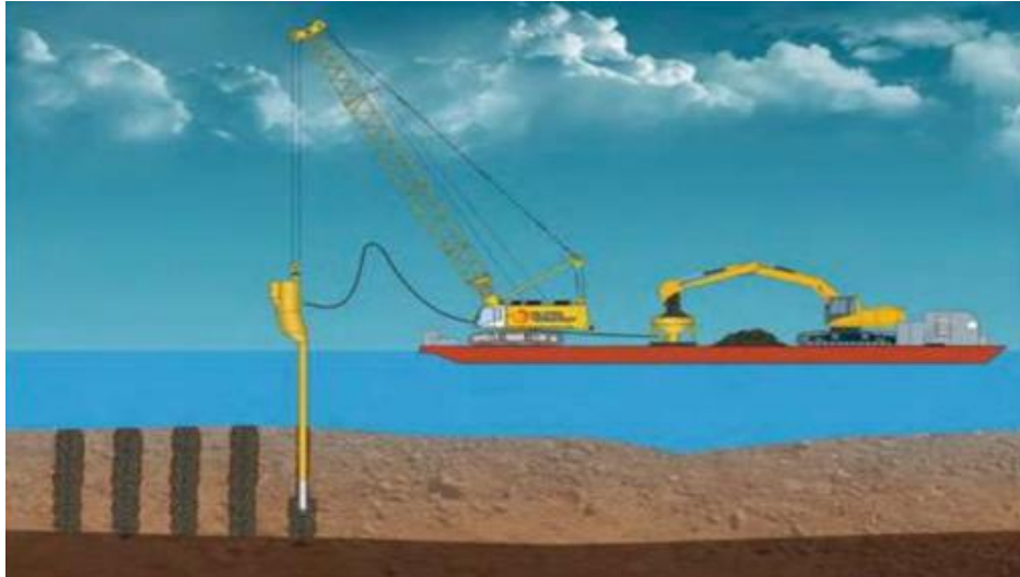
Figura 28 Instalación de columnas de grava en el mar.
