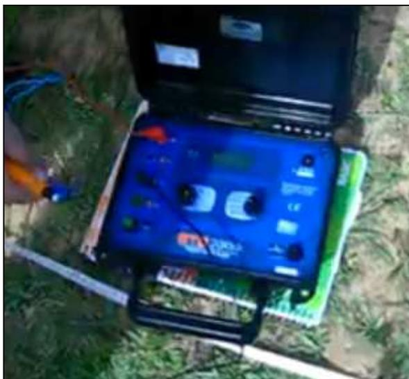
**Figura 2.11 Prueba de Resistividad del Terreno con Telurometro**
