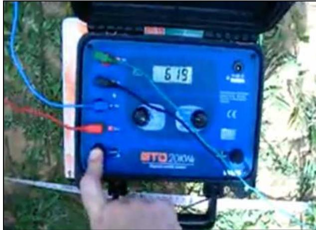
**Figura 3.12 Medición con método Wenner en suelo Limoncito igual a  $6.19\Omega$**
