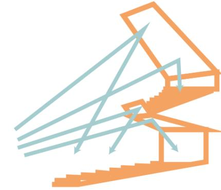
Se crea mediante techos inclinados ya que el elemento inclinado ya que crea reflexiones que inciden directamente al público
