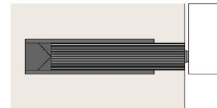
Apertura de puertas mediante sistema Push
