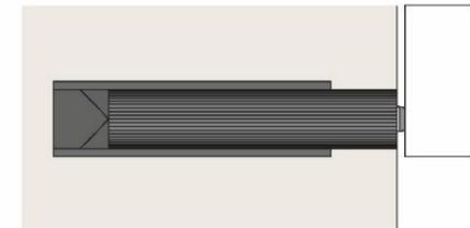
Apertura de puertas mediante sistema Push
