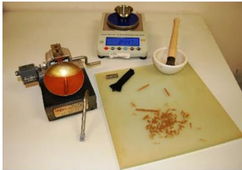
**Figura 2. Equipamiento para pruebas de plasticidad**
