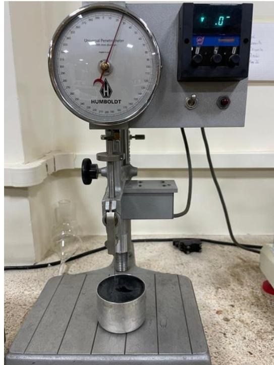
**Figura 32. Penetración del mástico M4 sin envejecer**
