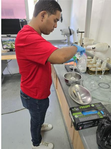
**Figura 14. Trabajo con el volumenómetro Le Chatelier**
