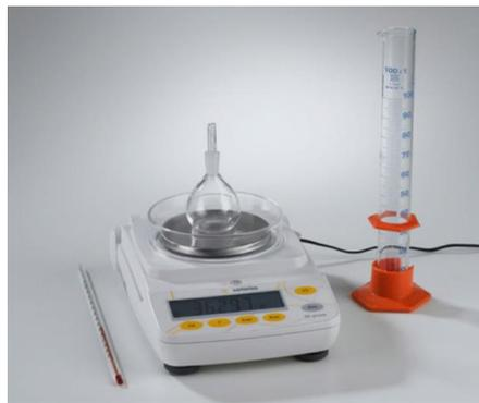
**Figura 3. Equipamiento para prueba de densidad**
