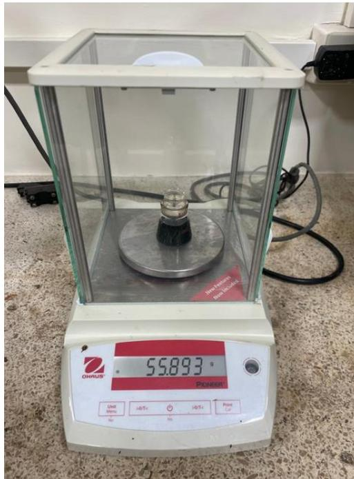
**Figura 30. Equipos empleados para determinar la gravedad específica**
