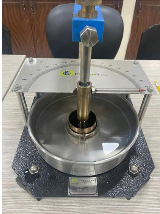
**Figura 38. Ensayo de recuperación elástica en el mástico M4 envejecido**
