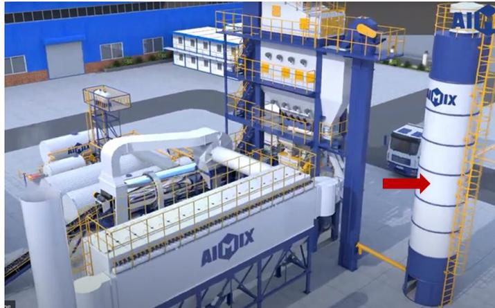
**Figura 16. Tolva de filler en una planta discontinua**
