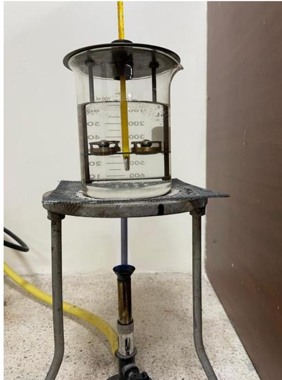
**Figura 34. Inicio de prueba de punto de ablandamiento Anillo y Bola**
