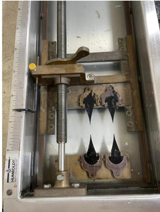
**Figura 36. Prueba de ductilidad en M2 con envejecimiento**
