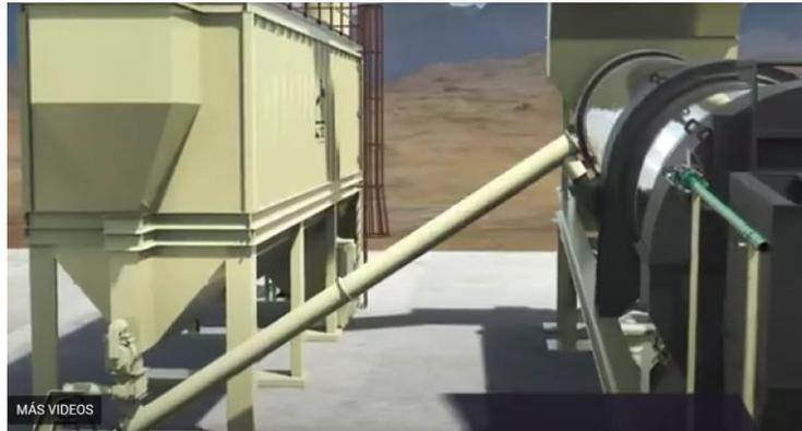
**Figura 19. Sistema para transportar fillers recuperados al tambor secador-mezclador**
