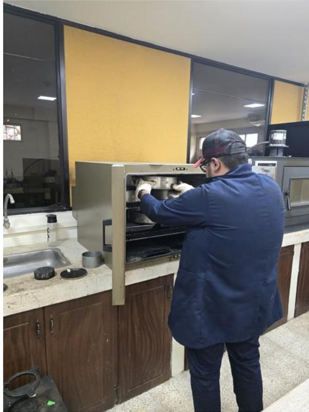
**Figura 22. Colocación de bandejas en horno con filler para secado**
