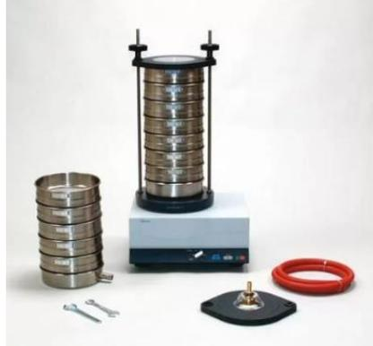
**Figura 1. Equipamiento para granulometría con tamices**
