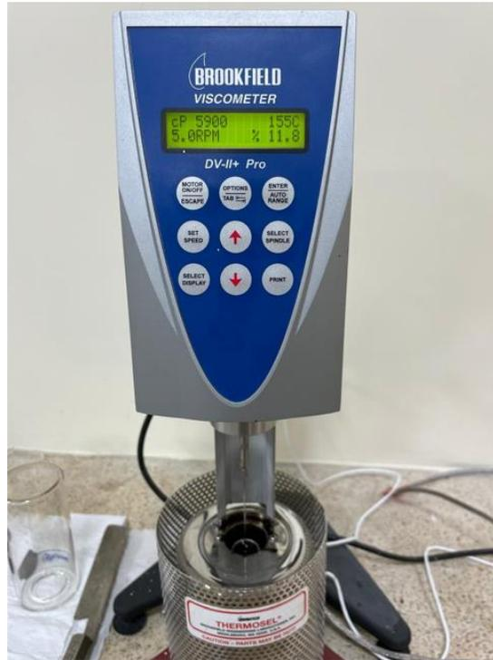
Figura 24. Viscosidad del mástico M4 sin envejecer a 155°C
