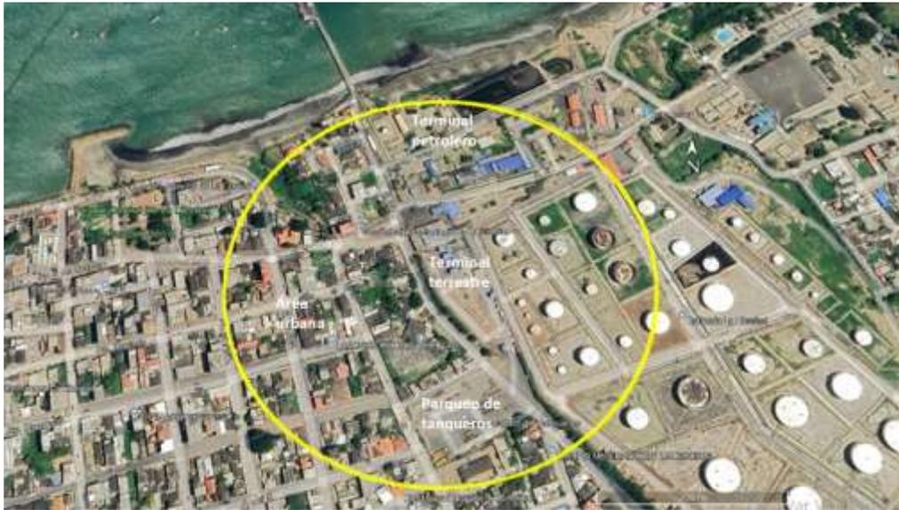
**Figura 5.** Círculo con radio de seguridad alrededor del terminal terrestre de productos limpios. Se observa el sector urbano que se encuentra dentro del área.
