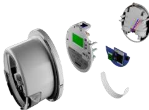
Figura 20 Easymetering Smart Meter
