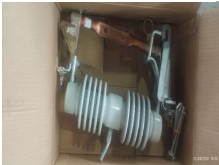
Imagen A 7 Seccionadores de 300amp
