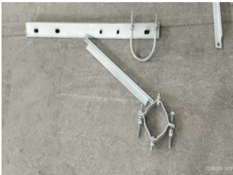
Imagen A 4 Estructura metálicas de 1,20m para seccionadores de 100amp
