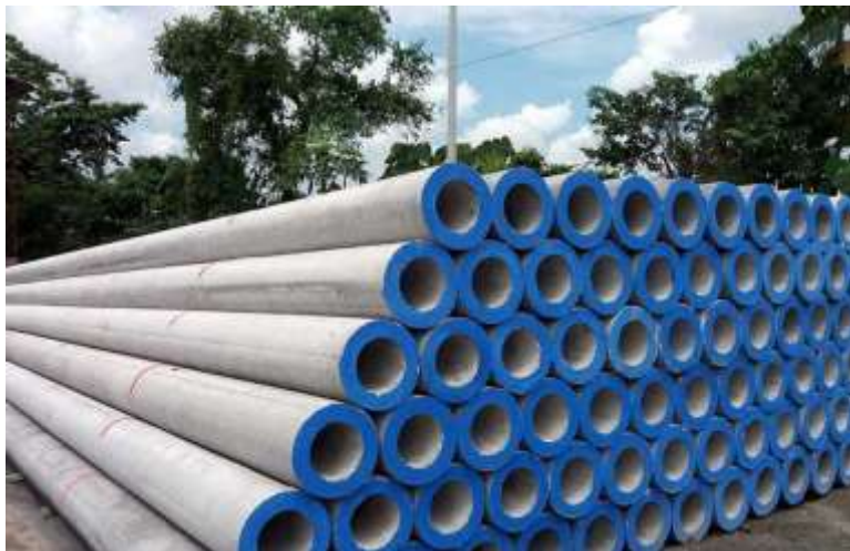
Imagen A 1 Poste de Hormigón Armado de 500KG y 2000KG
