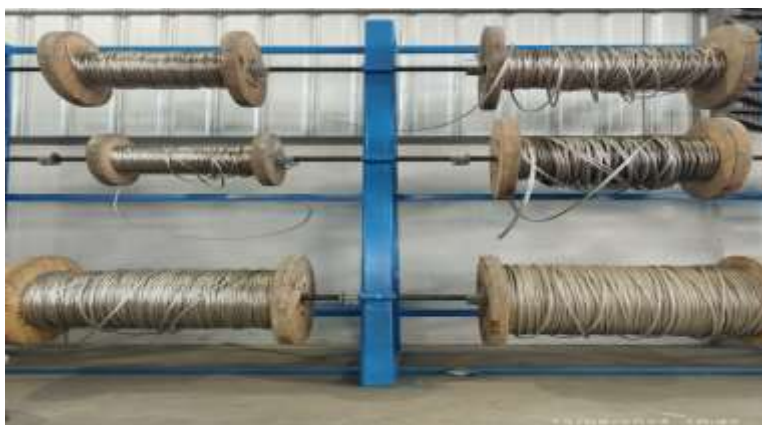
Imagen A 2 Conductores de Aluminio calibre 1/0, 2/0, 4/0
