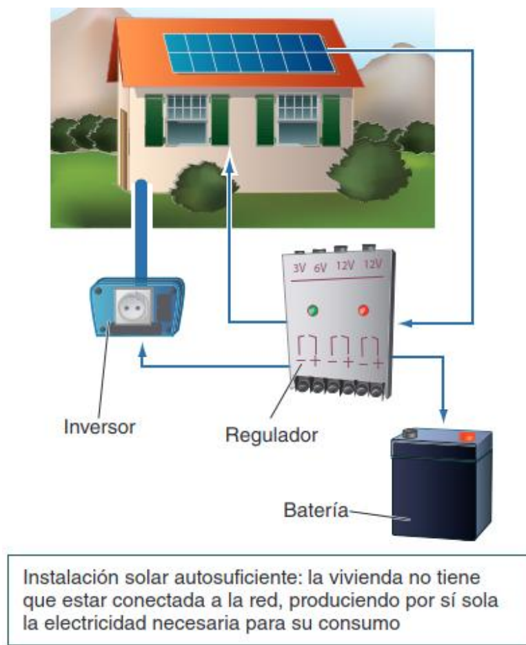
Figura 8: Sistema solar fotovoltaico autónomo Fuente: cairographicorg
