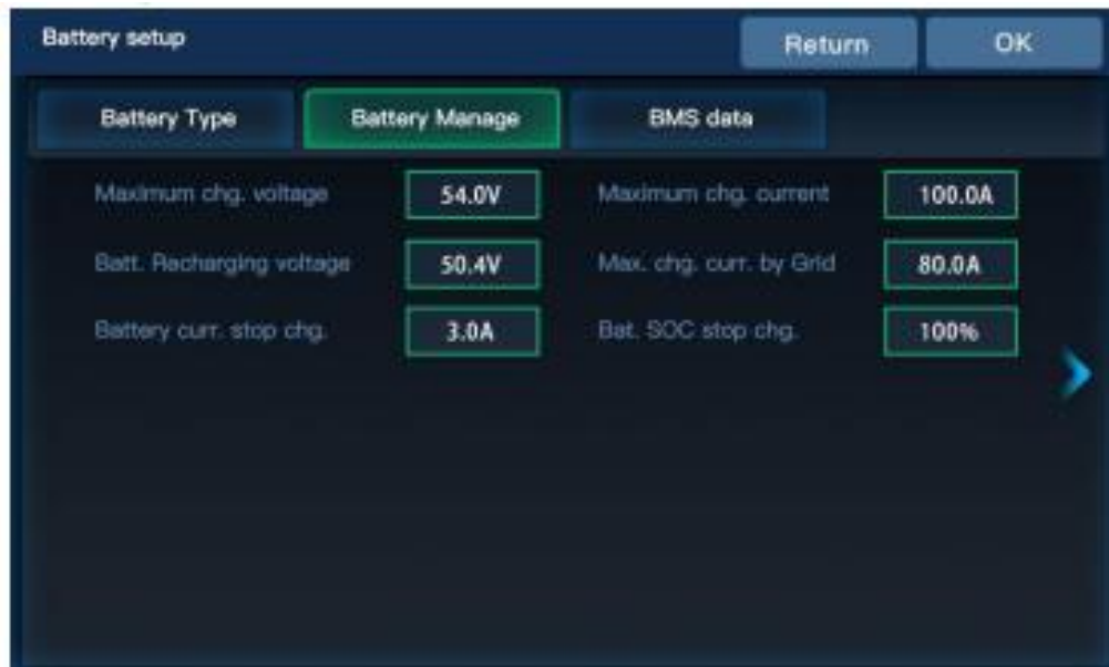
Ilustración 19. Interfaz para la configuración de los parámetros de gestión de la batería
