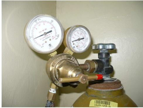
*Figura 3.22: Presurización (con nitrógeno) de Guía de Onda*
