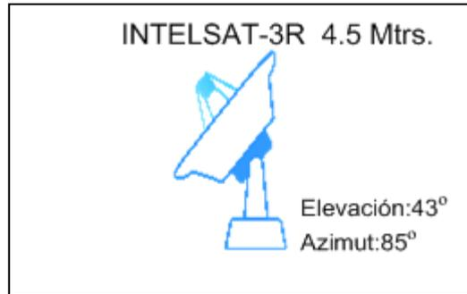
Figura 3.4: Antena de Recepción INTELSAT 3R
