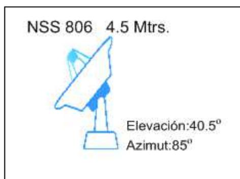
Figura 3.7: Antena de Recepción NSS – 806
