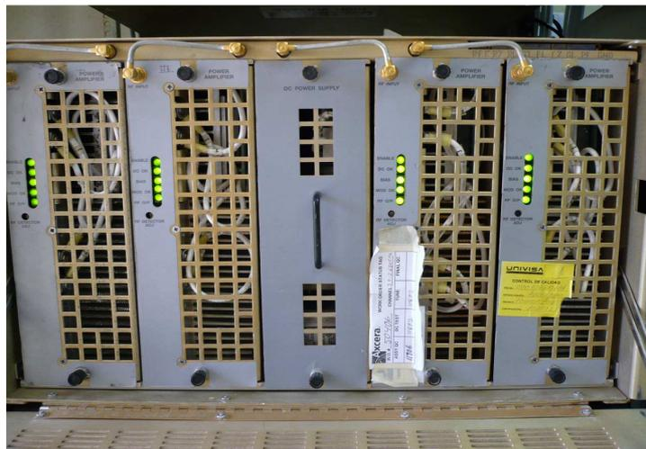
*Figura 3.17 – Módulo al 100% de Amplificación*
