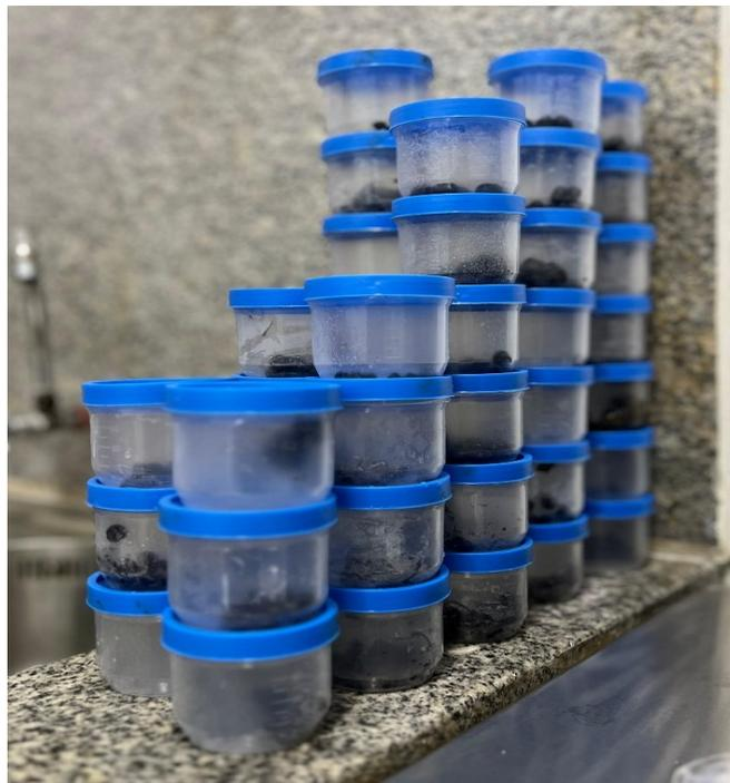
**Anexo 17.** Tubos de ensayo con solución salina saturada utilizados en el coprológico de flotación mediante la técnica de Willis.
