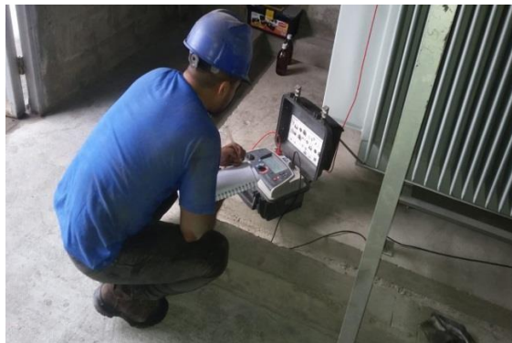
Figura 14: Prueba de índice de polarización a transformador
