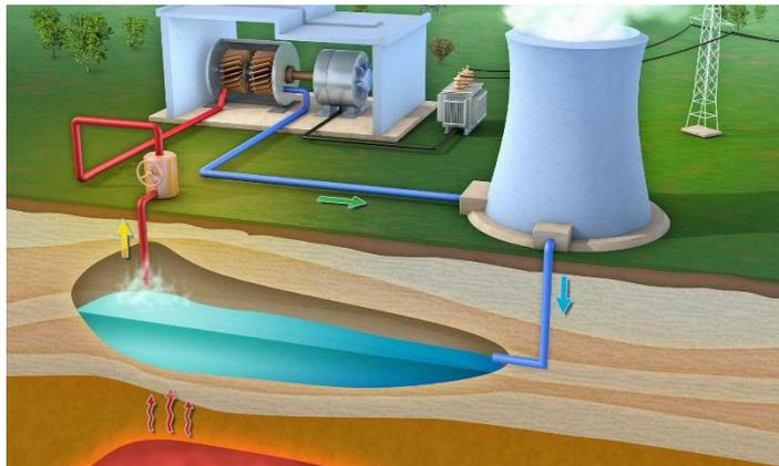
Nota: Funcionamiento interno de una planta geotérmica. Fuente: futuroelectrico 2019
