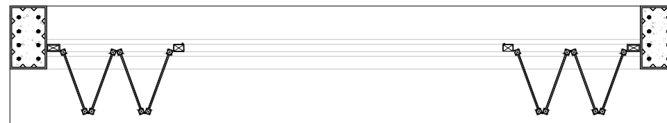
SECCIÓN EN PLANTA I2 VENTANA ACORDEÓN EBC 150
