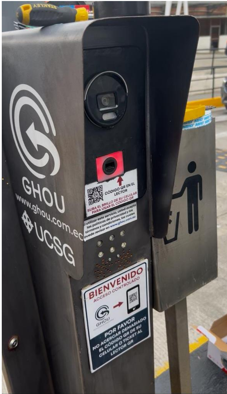
Anexo 6. Detalle frontal del módulo lector de código QR del sistema de control de acceso.
