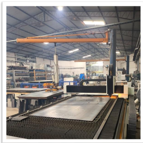
Figura 28 Láminas de acero colocadas para corte laser.
