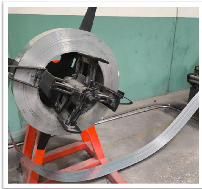
Figura 24 Rollo de lámina metálica puesta en la Fábrica.
