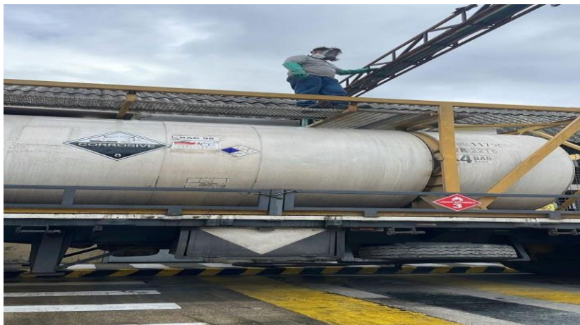
Ilustración 2: Trabajo en altura sobre isotanque
