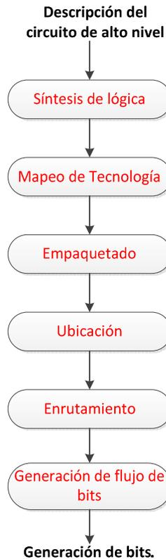
Figura 2. 8: Configuración del flujograma para FPGA.
