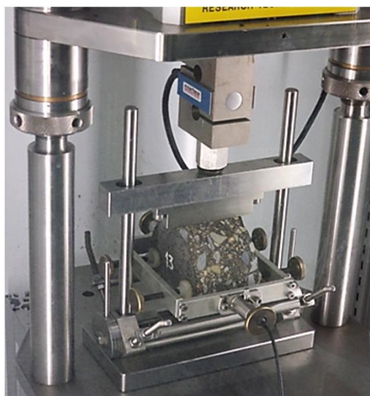
Figura 11. Dispositivo para colocación de transductores (LVDT)
