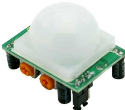
Figura 2.13: Sensor de movimiento PIR HC-SR501.
