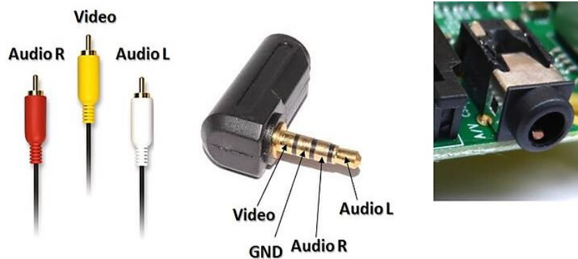
Figura 2.7: Puerto de salida de tipo RCA en la Raspberry pi.
