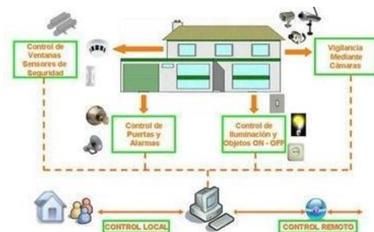
Figura 2.19: Control de aparatos en una casa inteligente.
