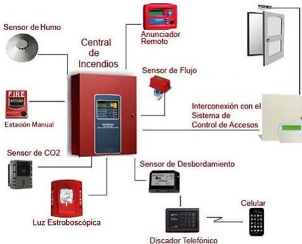
Figura 4 Sistemas contra incendios manejables con IoT
