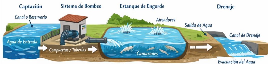
Figura 1. Esquema general de un sistema camaronero en estanques: captación–bombeo–ingreso–cultivo–drenaje
