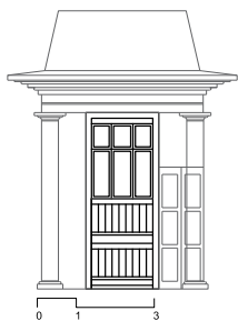
Detalle 2- Ventanas con tableros
