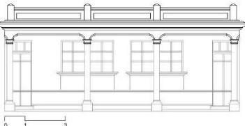
DETALLE 1- Cornisas molduradas y cubierta con pináculos
