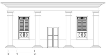
DETALLE 2- Ventanas de chazas con celosías ornamentadas y antepecho balastrado
