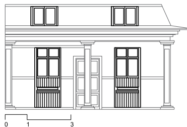
Detalle 2- Ventanas con tableros
