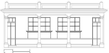
DETALLE 2- Ventanas enmarcadas y antepecho macizo
