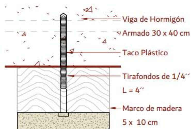
3 Detalle 5- Unión Muro Viga
