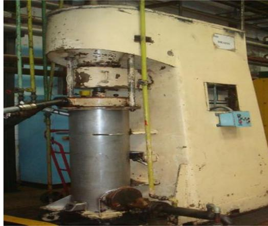
5. **PRENSADO.-** Se realiza el prensado del licor de cacao para obtener manteca y torta de cacao. El licor entra a la prensa formada por 12 filtros y un gran pistón que trabaja con una bomba de a 300 lbs y luego pasa a la de 500lbs de presión, por la presión ejercida sobre el licor se extrae la manteca y los sólidos son retenidos por filtros de mallas metálicas para formar la torta de cacao.
