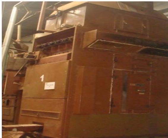
3. **DESCASCARADO.-** Debido al calentamiento del cacao en grano la cascara que se encuentra adherida se separa facilitando con ello la etapa del descascarado que consiste en que el cacao es triturado por una maquina llamada rompedor reflex en donde el cacao y las cascarras
