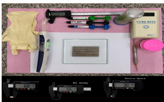
Figura 3. Materiales y especímenes utilizados para la evaluación de la profundidad de polimerización con lámpara Woodpecker O star de mediano costo y resinas Bulk. Fill, A1 body y Resina Opaca.
