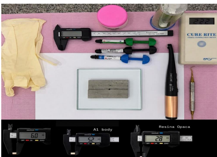
Figura 3. Materiales y especímenes utilizados para la evaluación de la profundidad de polimerización con lámpara Woodpecker O star de mediano costo y resinas Bulk. Fill, A1 body y Resina Opaca.
