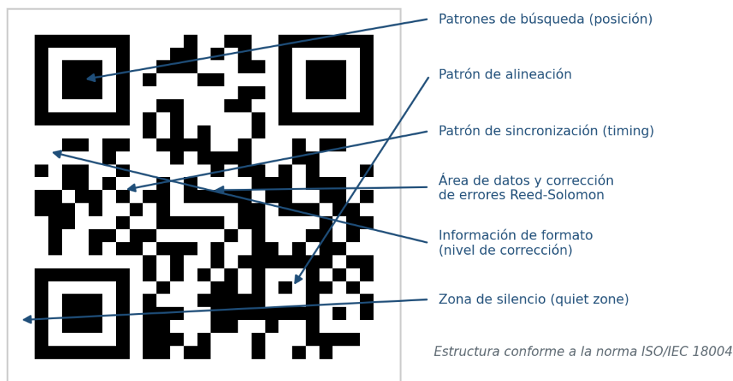
Figura 2.5. Elementos estructurales de un código QR según ISO/IEC 18004.
