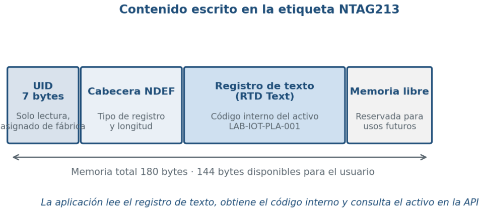
Figura 4.6. Estructura del contenido almacenado en la etiqueta NTAG213.
